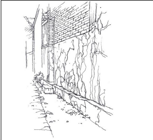
墙面：底部石砌，上部清水砖墙立面
